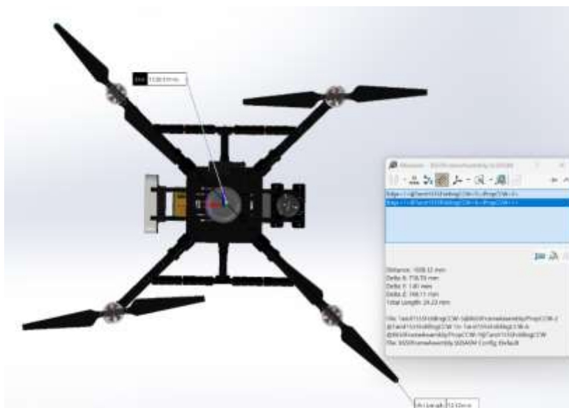
Εικόνα 33: Συνολική διάμετρος συμπεριλαμβανομένων και των ελίκων
