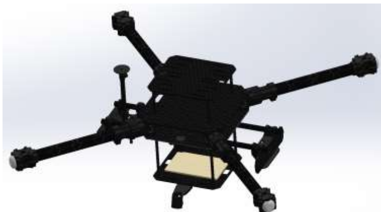
Εικόνα 3: Τρισδιάστατη (3D) απεικόνιση του πλαισίου Holybro X650
