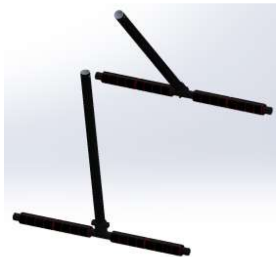
Εικόνα 13: Τρισδιάστατη (3D) απεικόνιση του συστήματος προσγείωσης
