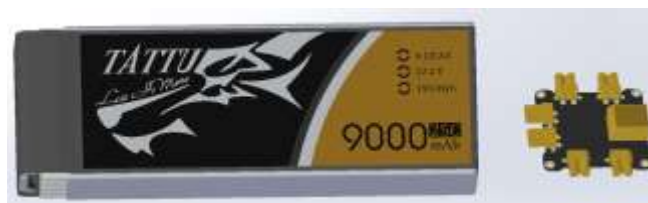
Εικόνα 4: Τρισδιάστατη (3D) απεικόνιση της μπαταρίας λιθίου πολυμερούς (LiPo) και του συστήματος διανομής ισχύος
