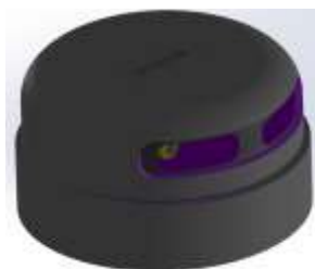
Εικόνα 11: Τρισδιάστατη (3D) απεικόνιση του αισθητήρα σάρωσης για δισδιάστατη (2D) σάρωση
