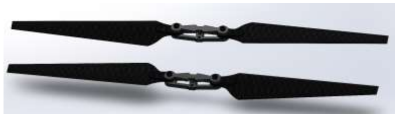
Εικόνα 12: Τρισδιάστατη (3D) απεικόνιση του έλικα CW (πάνω) και CCW (κάτω)
