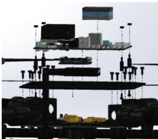
Εικόνα 23: Τοποθέτηση εξαρτημάτων 1ου επιπέδου
