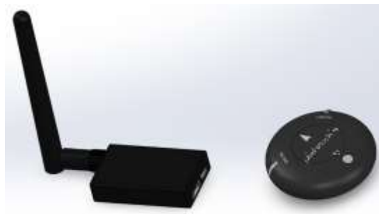
Εικόνα 8: Τρισδιάστατη (3D) απεικόνιση μονάδας τηλεμετρίας και δορυφορικής
