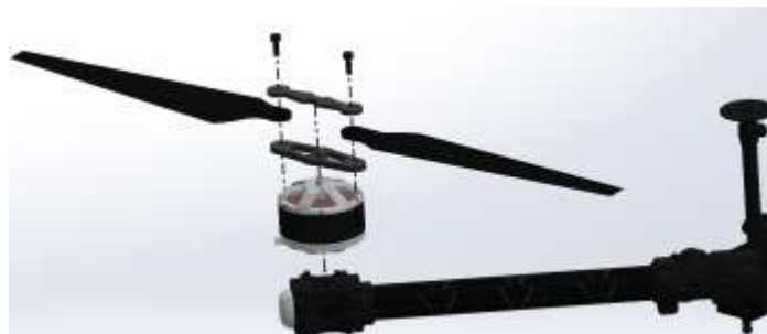
Εικόνα 21: Τοποθέτηση και συναρμολόγηση τμημάτων κινητήρα
