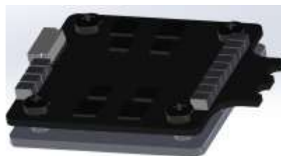
Εικόνα 5: Τρισδιάστατη (3D) απεικόνιση του ηλεκτρονικού ελεγκτή ταχύτητας
